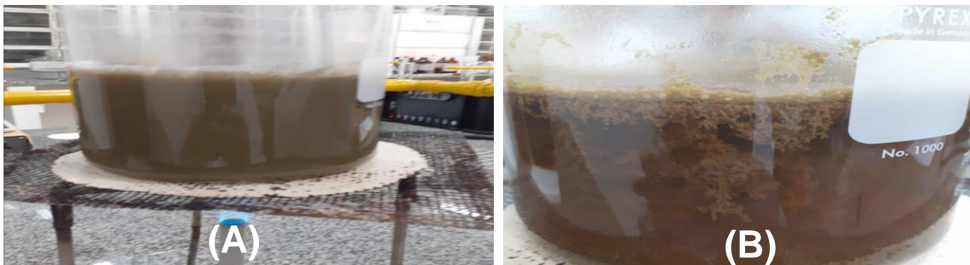
Figura 4 – Aquecimento da solução decantada contendo NaOH e sacarose (A) início da ebulição e (B) formação de precipitados de óxido de prata.
