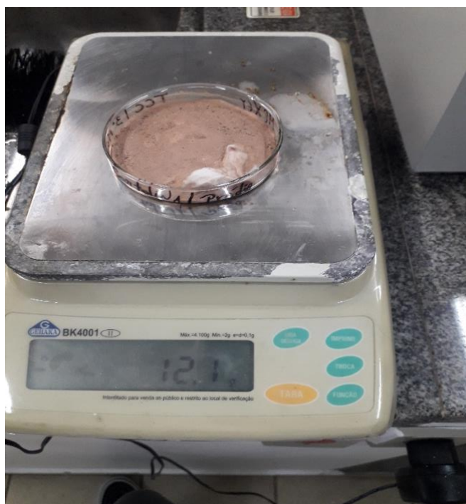
Amostra de Cartolina + Algodão em balança semi-analítica (IMAGEM 9)
