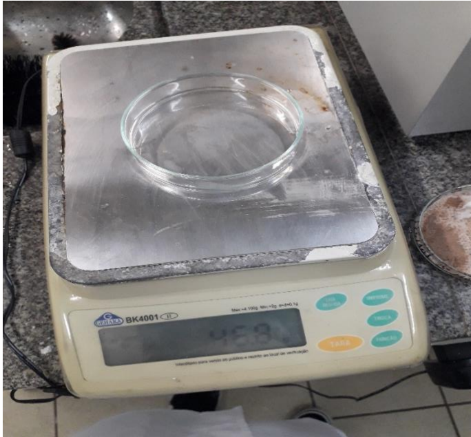
Tara da placa de Petri em balança semi-analítica (IMAGEM 6)
